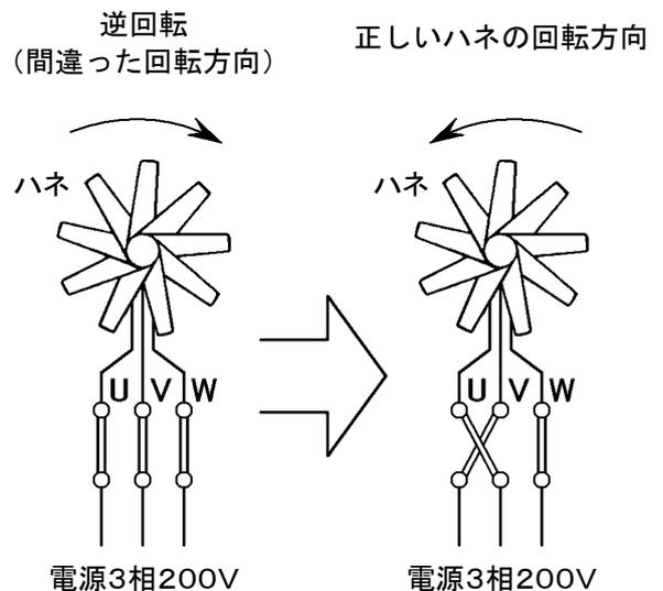
※ハネ回転方向は、吸気側から見て左回転(反時計回転方向)です。
